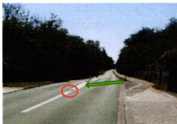
Figure 1.4.b Extrémités de la piste cyclable à Villeherviers. La ligne discontinue (en rouge) est positionnée en face de l'entrée et non de la sortie - Photos : Cerema
